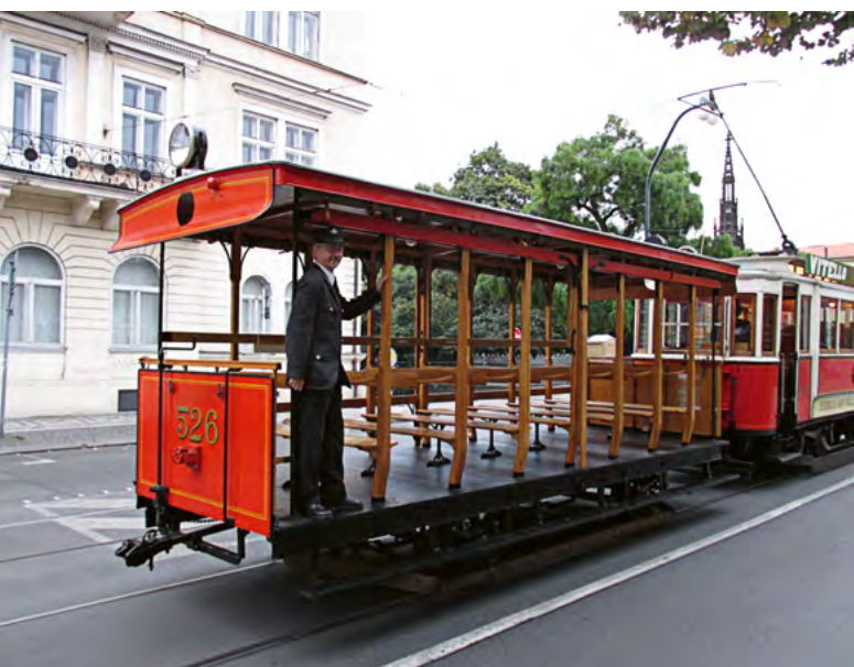
Vlečný vůz ev. č. 526 vznikl v roce 1905 přestavbou z původního vozu koňky ev. č. 226 (vyrobený v roce 1899). Až v roce 2001 byl rekonstruován na muzejní exponát. Záběr ze Smetanova nábřeží pochází z 20. září 2015. Foto: Zdeněk Liška
