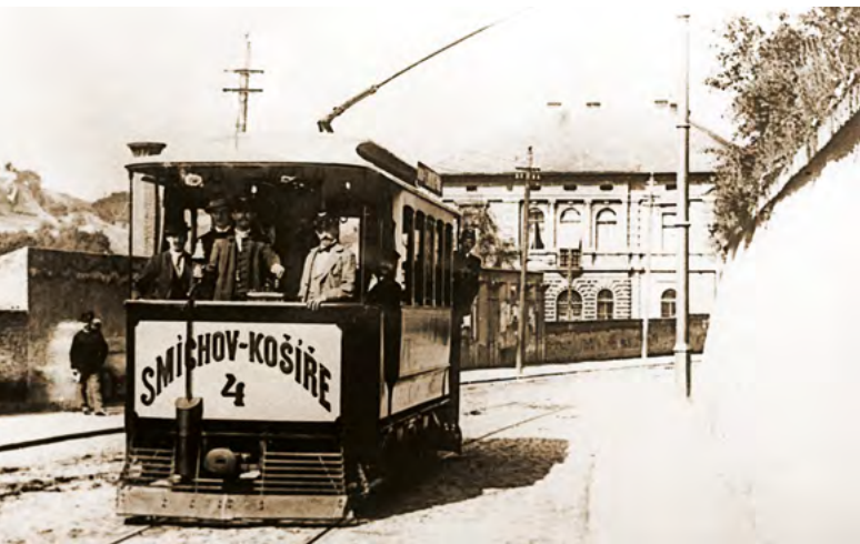
Motorový vůz ev. č. 4 v Košířích v roce 1897. Ze záběru je patrné použití trolejového vedení a vychýleného sběrače podle systému Alfreda Dickinsona. Zdroj: sbírka Tomáš Dvořák
