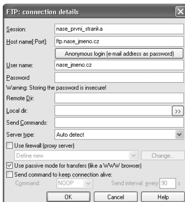
Obr. 1.7: Vytvorenie nového spojenia FTP v aplikácii Total Commander
