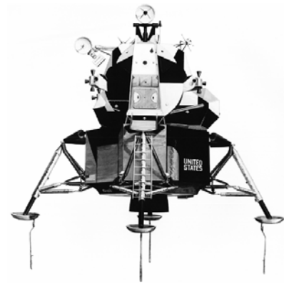
Přistávací sekce (lunární modul) kosmické lodi Apollo
