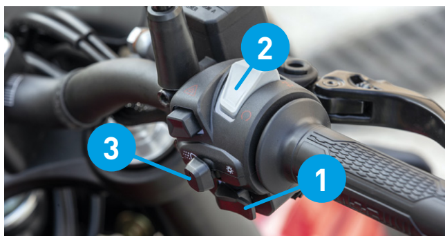
1 - startér / 2 - nouzové zhasínání motoru / 3 - vypínač světel
